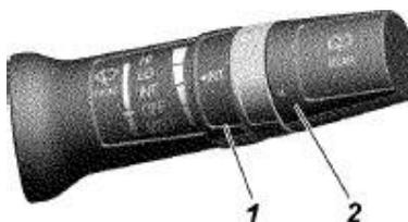
IV – activado el modo constante (alta velocidad) de trabajo del limpiaparabrisas del parabrisas. Posición fija.
