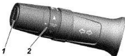
Fig. 3.7. Controles de la computadora de ruta en la palanca izquierda del interruptor bajo el volante:
