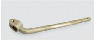
Palanca de cambio de velocidades ; caja de transferencia
