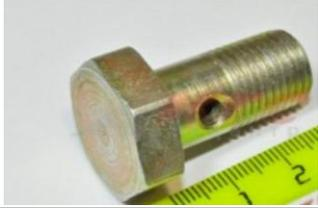
Perno con orificio para direccion hidraulica
