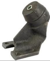
Soporte de motor con buje ; Motor
