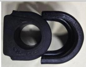
Buje de barra estabilizadora con soportes
