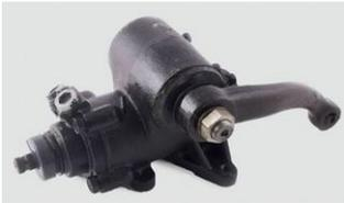
Mecanismo de direccion con palanca de
