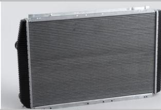
Radiador de sistema de enfriamiento de motor ; de aluminio
