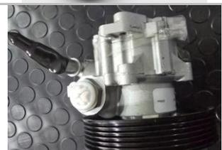
Bomba de direccion ; hidraulica
