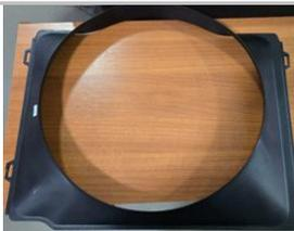
Forro de acero para ventilador y radiador
