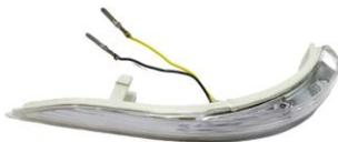
Repetidor en retrovisor de guiñador ; derecho
