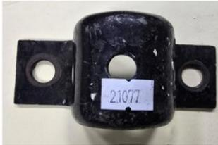
Abrazadera de barra estabilizadora
